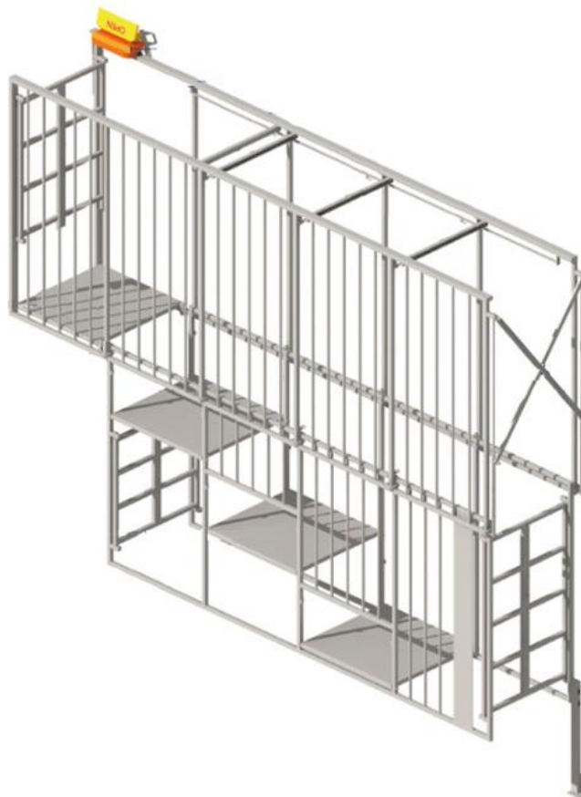
Hình B.17 – Ví dụ minh họa thang thoát nạn khẩn cấp tích hợp lan can tự hạ ở mặt ngoài nhà (trạng thái mở để thoát nạn của một phân đoạn thang trong phạm vi 1 tầng)
